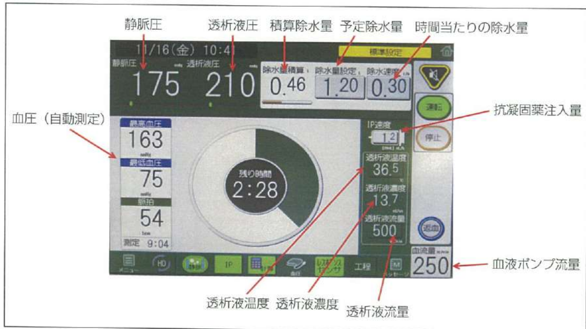
図3 操作パネル さまざまな治療条件の設定は操作パネル上で行われる。
